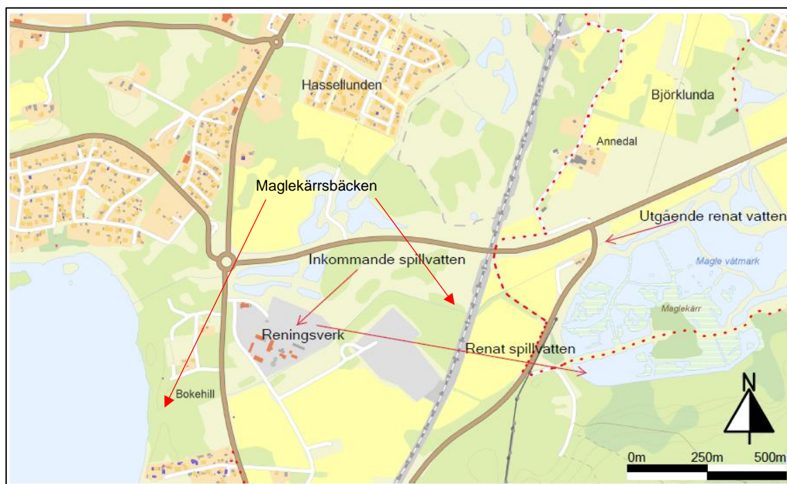
Figur 9 Översiktlig bild som visar stegen i rening av spillvatten. Källa: Hässleholms Vatten AB.
