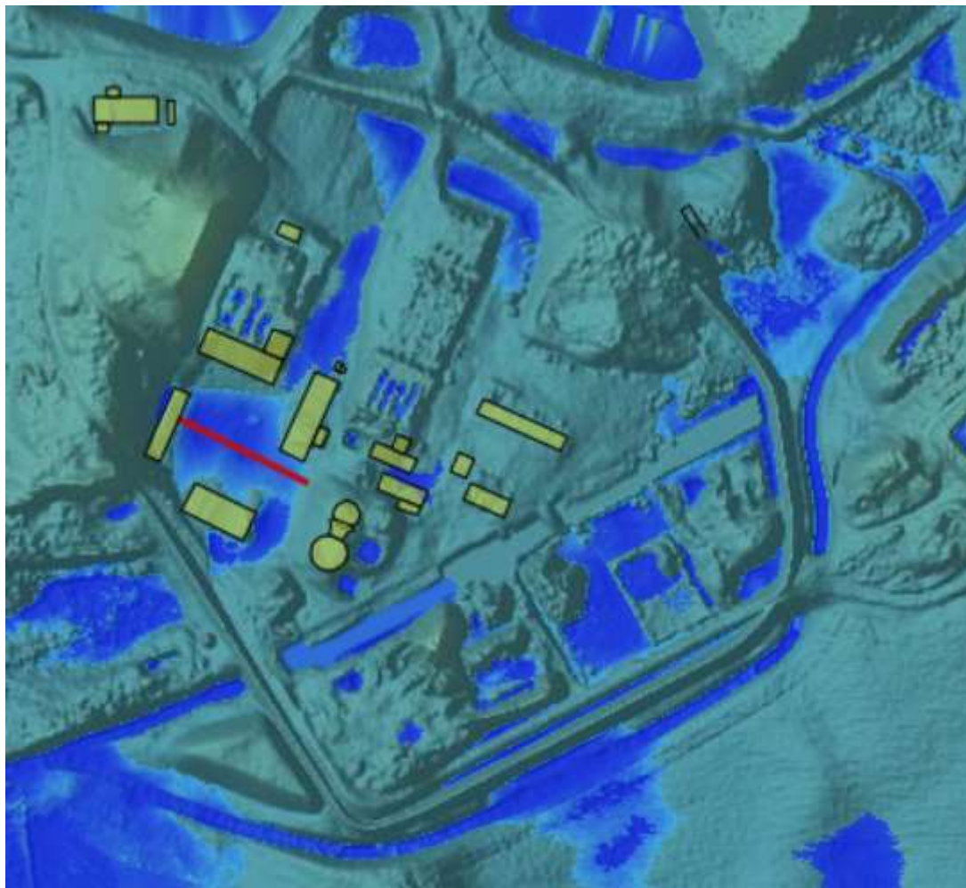
Figur 6 Resultatet från översvämningsanalysen i Scalgo. Blå områden visar översvämningsområden. Ju mörkare blå färg desto djupare vattennivå är det. Den röda linjen markerar platsen för tvärsektionen som visas i Figur 7.
